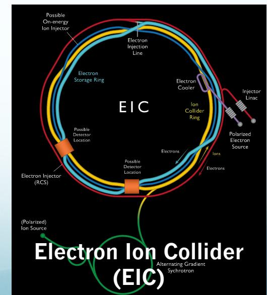
**Electron Ion Collider (EIC)**
