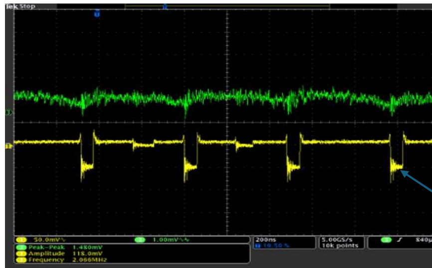
Vout Noise/ ripple ~1.5mV (1mV/div) h.200ns
