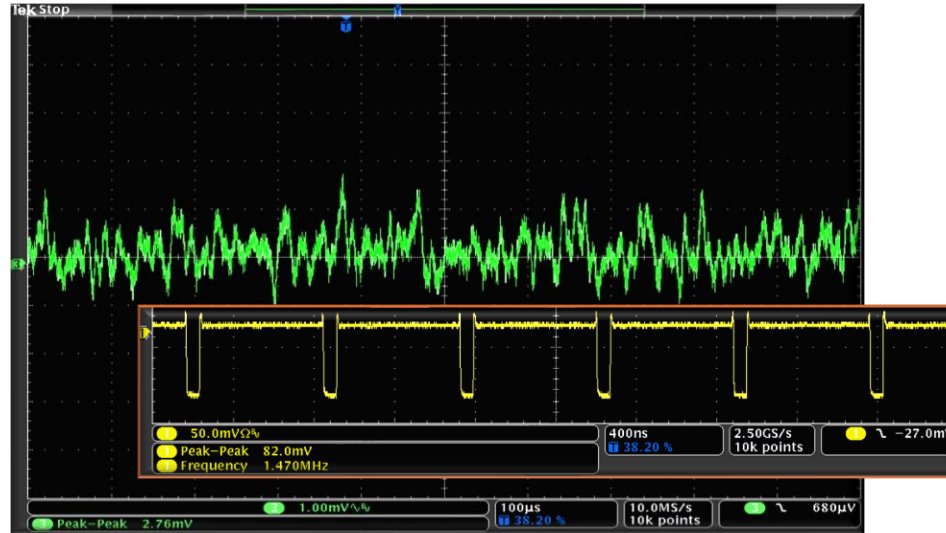
Vout Noise/ ripple ~3mV (1mV/div) h. 100us
