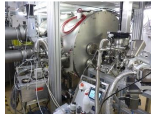
bERLinPro ERL medium power SRF gun cavity cold string
